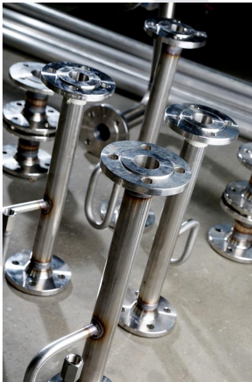
Anfertigung von Paßstücken für eine Kühlwasserleitung
