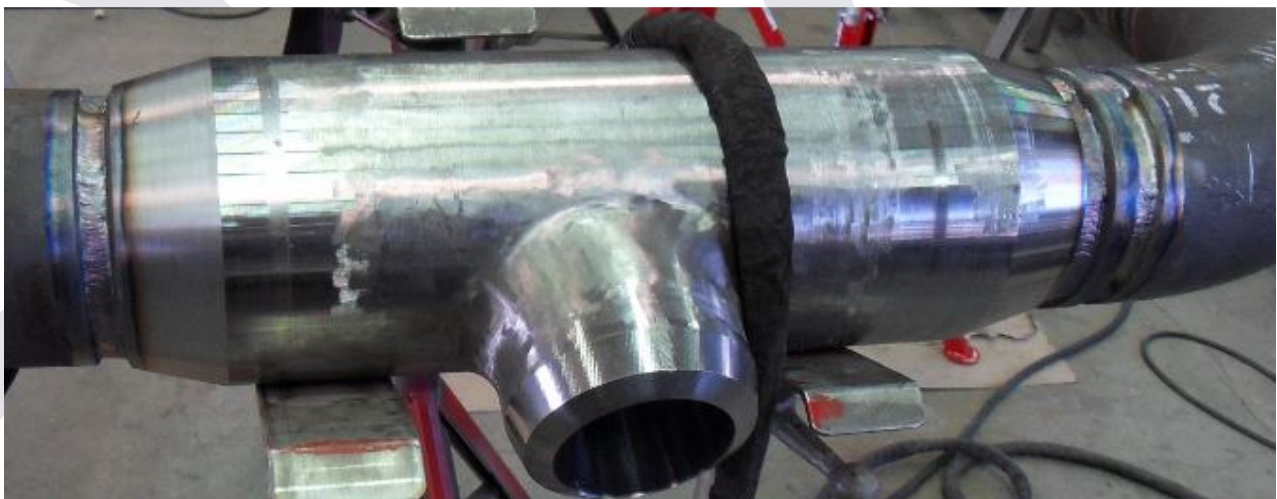
Rohrleitungsbauteil für Wasserhydraulik, Betriebsdruck 210 bar – Nennweite DN125/100 Werkstoff S355J2H Wandstärke 17,5 mm
