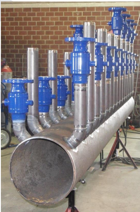
Heizungsverteiler nach Druckgeräterichtlinie 97_23 EG Modul G
