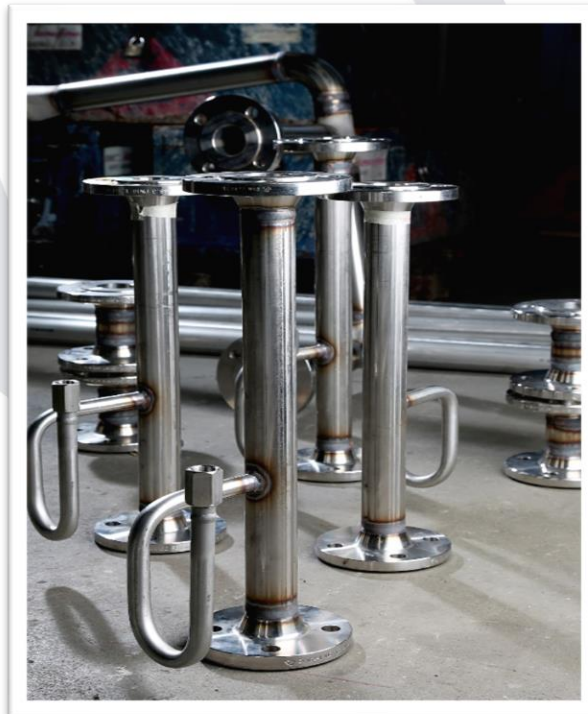
Bauteile für eine Dampfversorgung, Werkstoff: P 235 GH1
