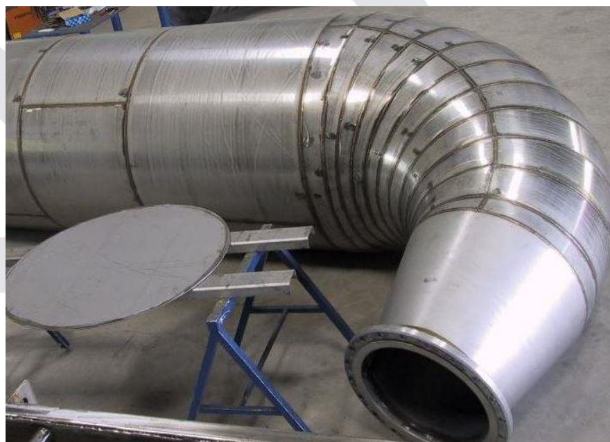
Beschleunigungsbogen DN 900 Werkstoff 1.4571
