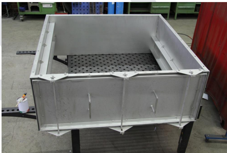
Filterkasten in Werkstoff 1.4571 für eine Absauganlage
