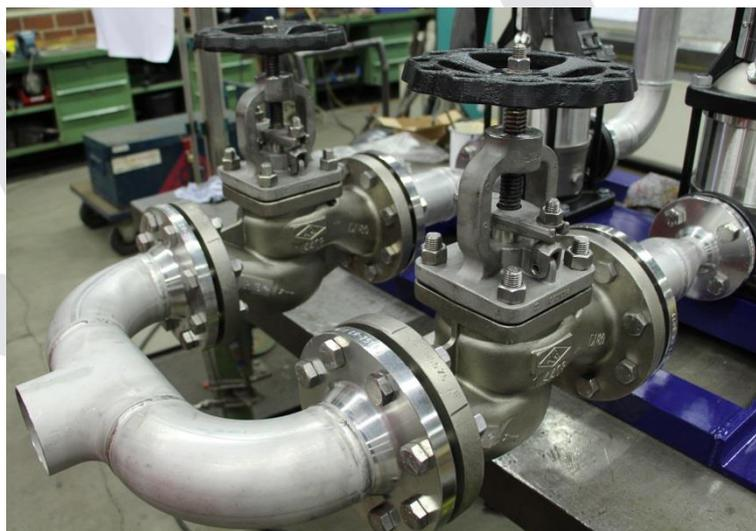
Vormontage Kondensatheberstation Werkstoff 1.4571
