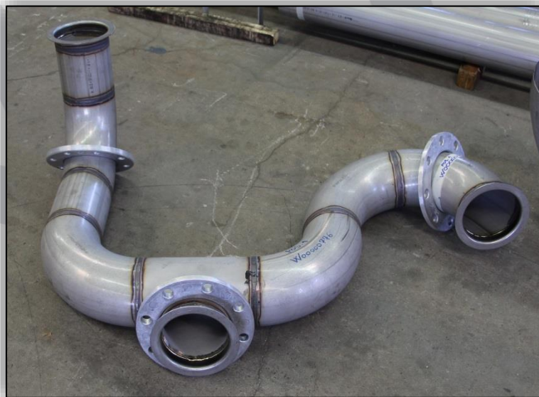
Vorgefertigte Rohrleitung 219,1x2,9 - Werkstoff 1.4571
