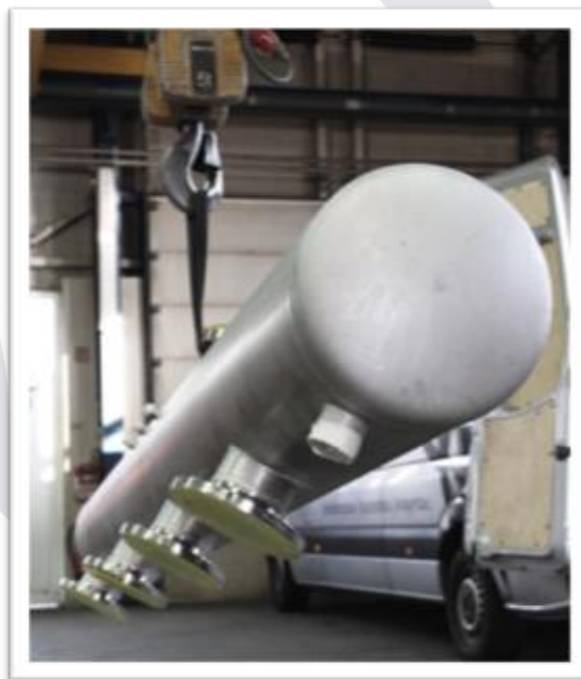
Hergestellter Druckluftverteiler DN250, Werkstoff 1.4571, inkl. Erstellung Konformitätserklärung, sowie Abnahme nach Druckgeräterichtlinie
