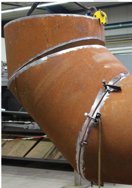
Vorfertigung eines Segmentbogens DN1000 für eine Abdampfrohrleitung in Werkstoff P235GH1C1
