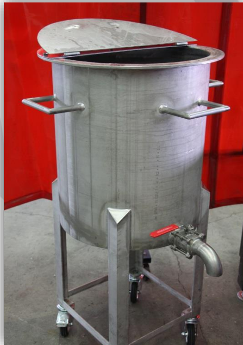
Sonderfarbenbehälter, Durchmesser 600mm, Werkstoff 1.4571
