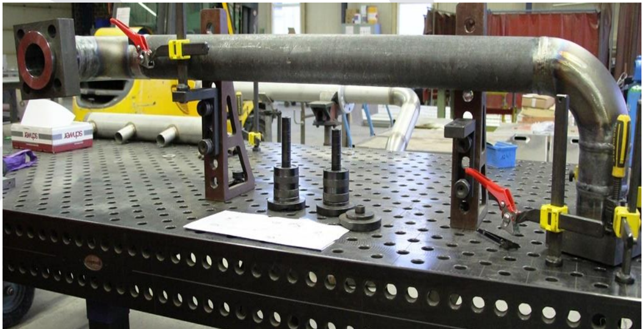
Hydraulikrohr PN 320, 114,3x17,5 Werkstoff S355J2
