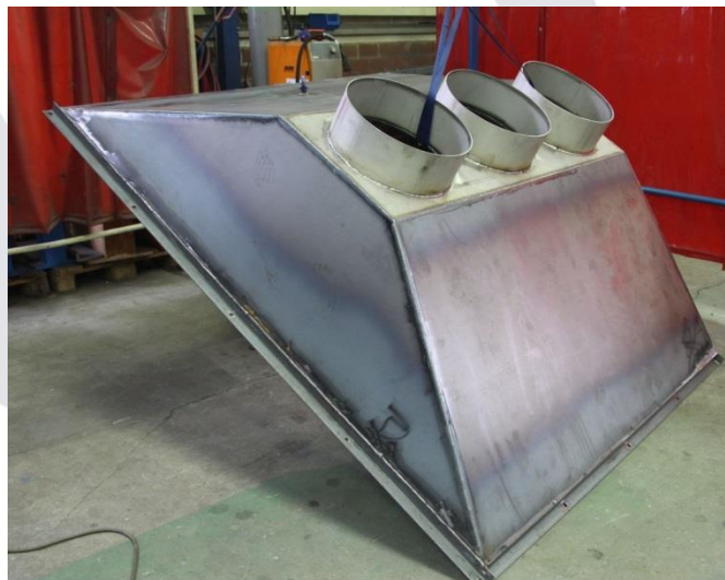
Ablufthaube mit Stutzen DN400, Werkstoff S235JR
