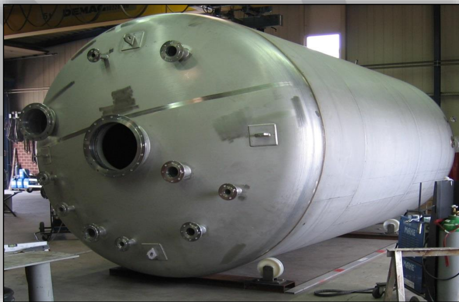
Waschbehälter, Werkstoff 1.4571 Höhe 6500 mm, Durchmesser 3000 mm
