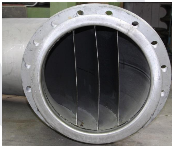
Abströmbogen DN400 mit Leitblechen in Werkstoff 1.4571
