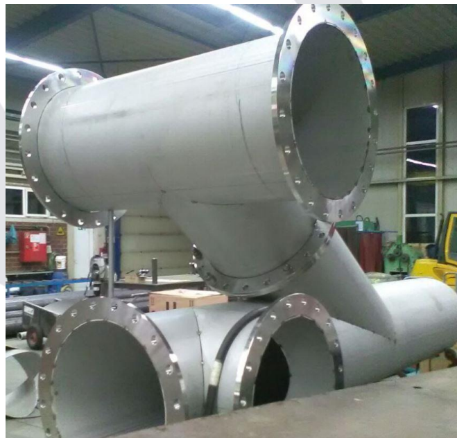
Vorfertigung Abgasverteiler DN 600 Werkstoff 1.4571
